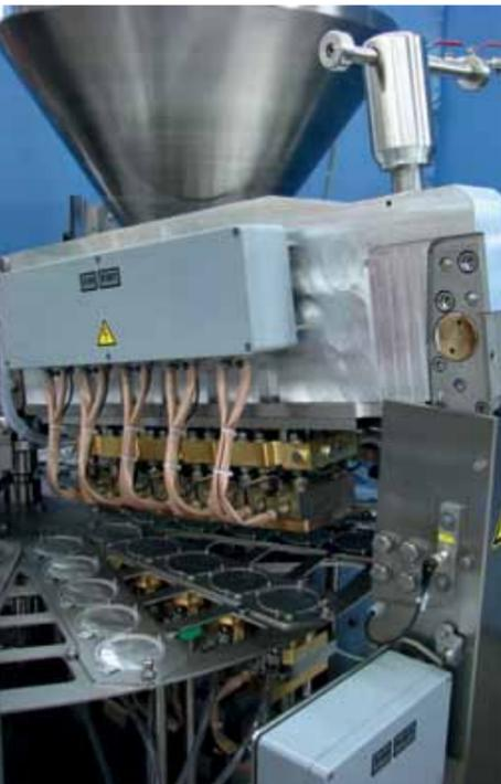
Kraftvolle servogetriebene Siegelstation. Als Gegenpart zur mechanischen Siegelbewegung von unten dient dem DOSOMATEN ein durch eine Luftkaskade abgedecktes Siegeloberwerkzeug. Siegelkräfte bis 1.200 kg/Bahn in nur 0,4 sek Siegelzeit sind Standardparameter.
