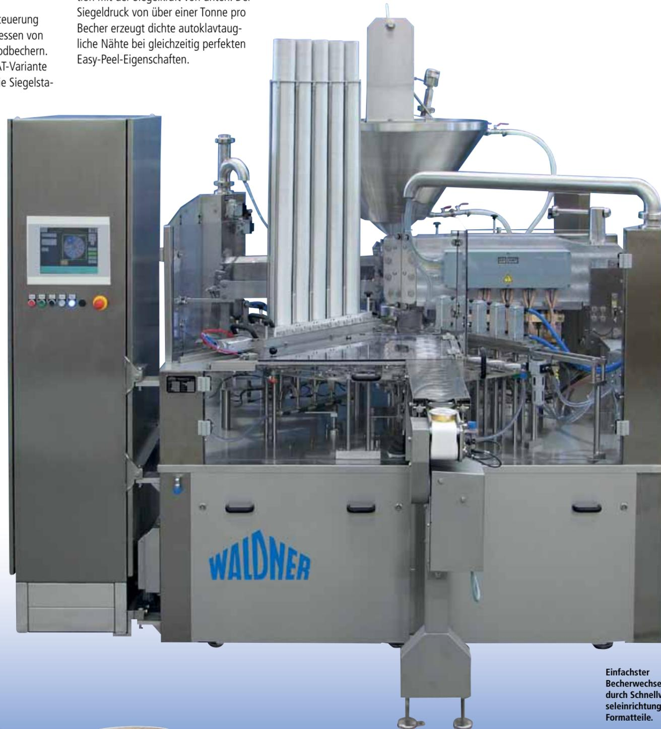
Einfachster Becherwechsel durch Schnellwechseleinrichtung der Formateile.
