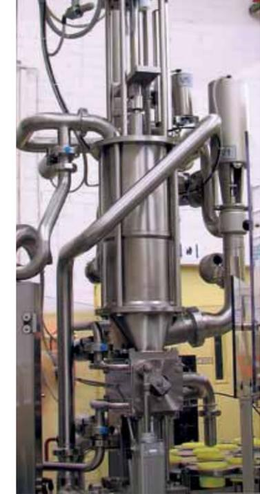
Kompensationszylinder zur Synchronisation von kontinuierlichem Produktzulauf und diskontinuierlichem Abfüllprozess
