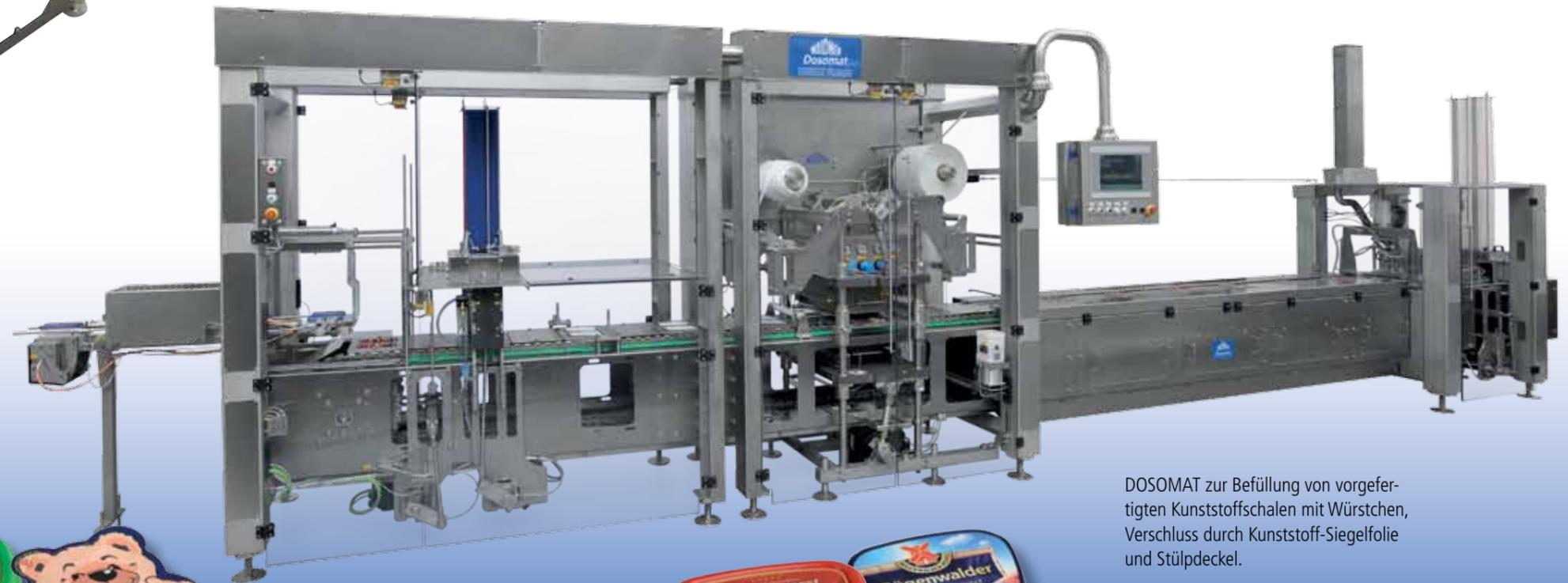
DOSOMAT zur Befüllung von vorgefertigten Kunststoffschalen mit Würstchen, Verschluss durch Kunststoff-Siegelfolie und Stülpedeckel.
