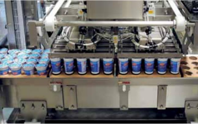
Servotriebener Greifer zum Entnehmen der Becher aus der Zellenkette. Zusammenfahren in 2 Achsen auf das Packschema der Steigen.
