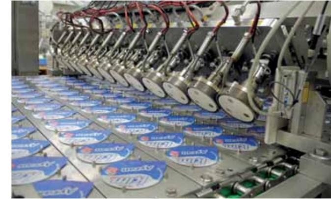
Schwenken der Siegelstation in die Servicestellung durch Knopfdruck bei einfachster Wartung, Kontrolle und Reinigung.
