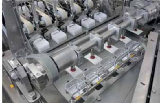
Pick'n Place System zum Einsetzen von Trocknungsmittel im Becherboden, mit doppelter Sensorik (pneumatisch/sensorisch).
