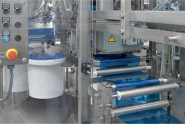
Rollensiegelstation mit Restfolienaufwicklung ohne Druck/Quetschbelastung der Eimerstruktur beim Siegeln.
