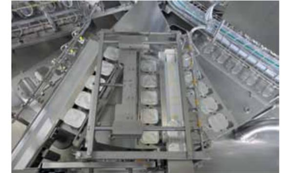
Ausschieben der fertigen Verpackung auf Gut- (zur Endverpackung) und Schlecht-Band mit Crosscheck. Wird eine Verpackung „schlecht geschrieben“ wird geprüft ob sie auf dem „Schlecht-Band“ ankommt und definitiv auf dem „Gut-Band“ fehlt.
