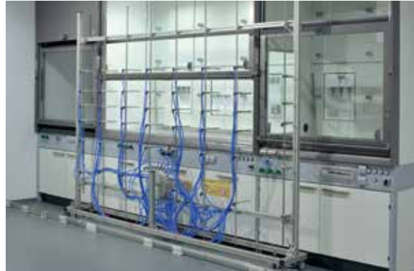
EN 14175-6, typgeprüfte Abzugsregelung nach 5.4 Messung in der äußeren Messebene
