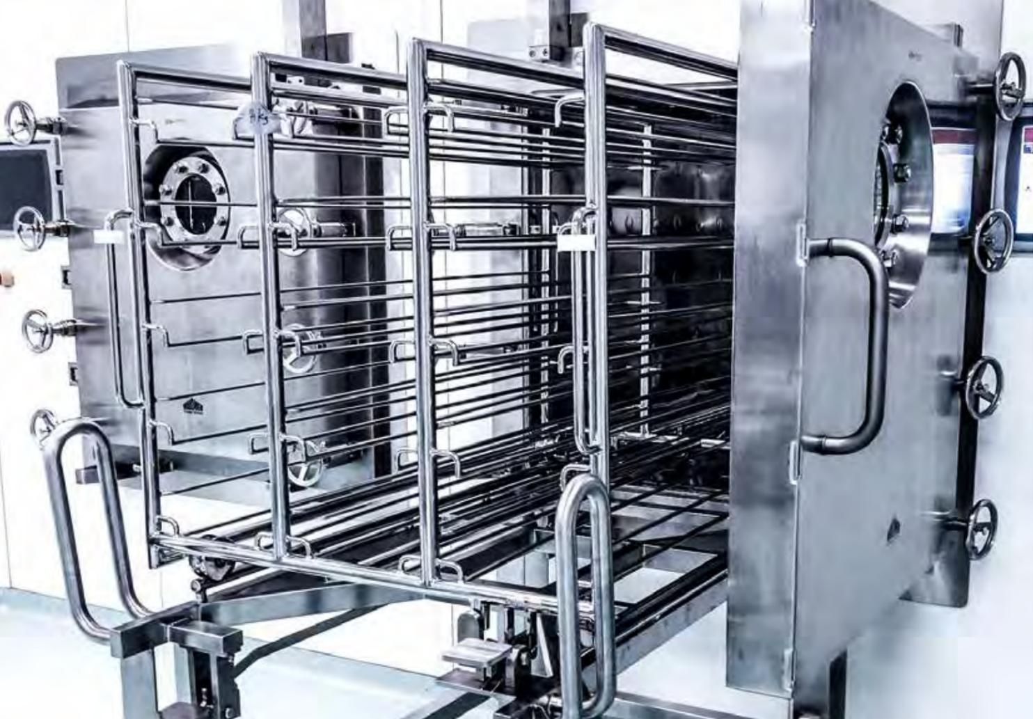
Vakuum-Trockenschrank mit einfahrbarem Hordenwagen zur Trocknung von Pharmaprodukten
