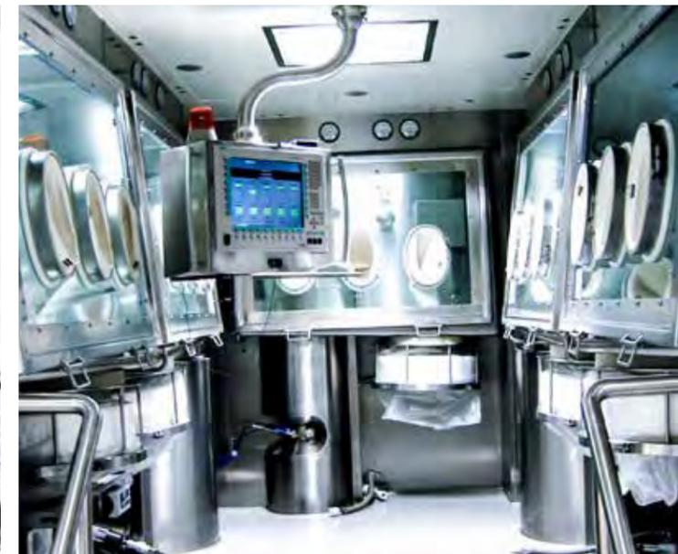
Isolatoren mit direkt integrierten Ansatzbehältern für die Parenteralia Produktion
