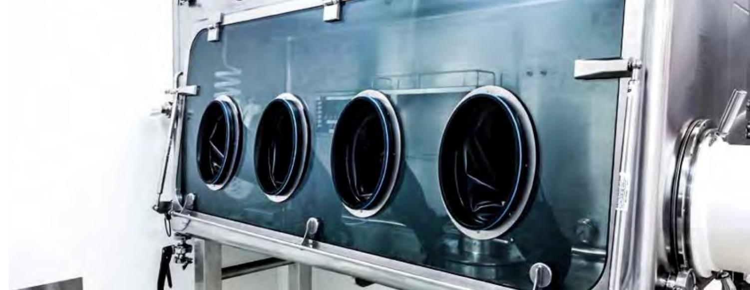
EX-Geschützter Isolator mit herausnehmbaren 1-Liter-Ansatzbehälter
