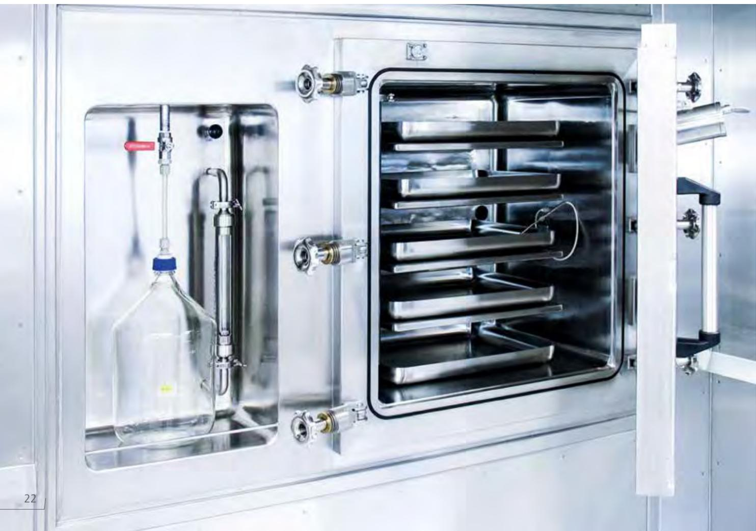
Package Unit in cGMP-gerechtem Design mit 1,0 m<sup>2</sup>-VTP-Vakuum-trockenschrank zur schonenden Trocknung von pharmazeutischen Wirkstoffen.
