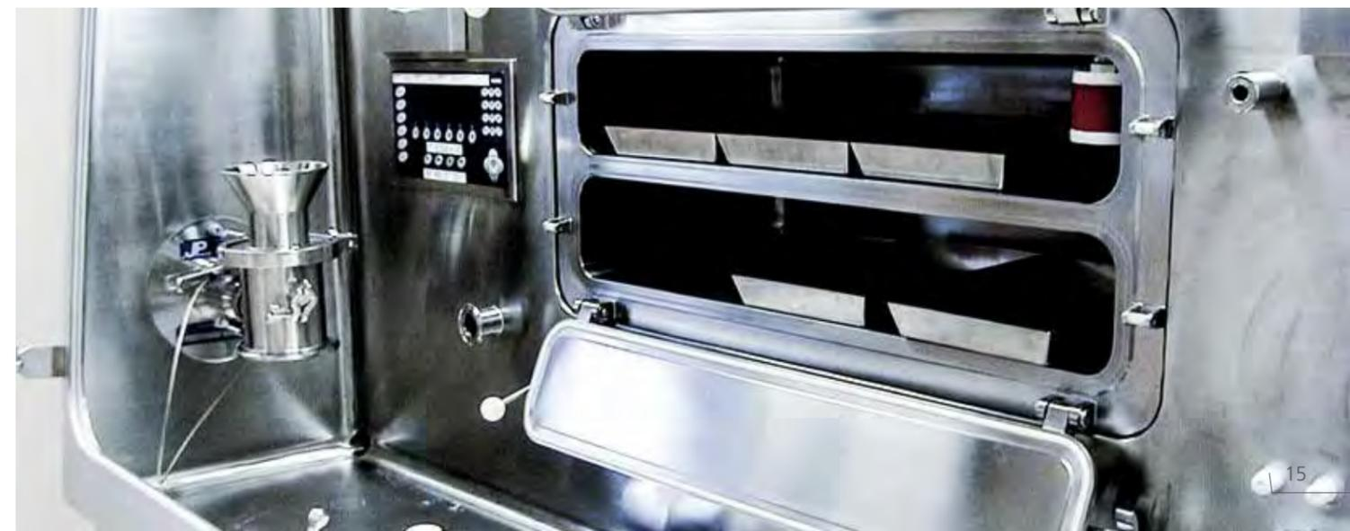
Isolator mit integrierter Siebmühle und Vakuum-Trockenschrank
