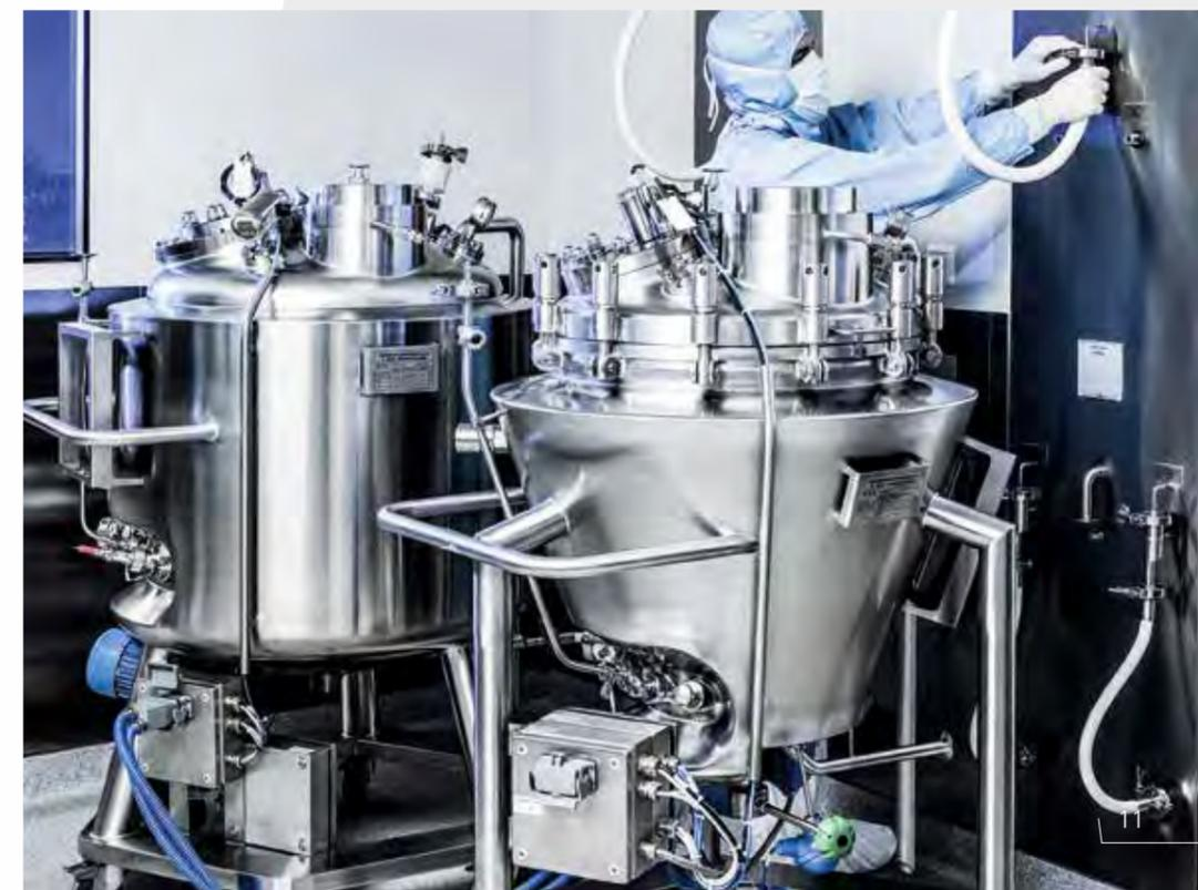
Mobile Ansatzbehälter am Abfüllpanel
